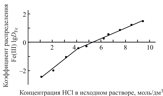
Рис. 1. Влияние концентрации хлороводородной кислоты на экстракцию \text{Fe}^{\text{III}} в многокомпонентной системе ( \text{FeCl}_3 – \text{HCl} – \text{H}_2\text{O} –ундекан-1-ол). Соотношение органической и водной фаз 1:1, c(\text{Fe}^{\text{III}})_{\text{исх}} 0.55 моль/л.
